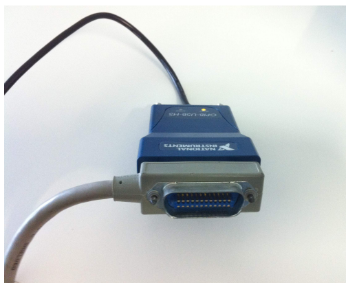
Figure 3.1 – Connecteur USB-GPIB (bleu) et câble GPIB (gris).
