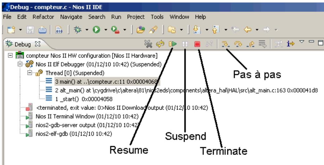
Un double-clic dans la colonne de gauche de la fenêtre du programme insère un point d'arrêt. Un autre double-clic l'enlève.
