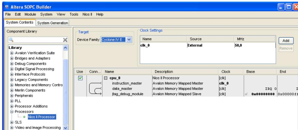
Dans la colonne de gauche, sélectionner la mémoire « on chip » puis faire « add ». Fixer la taille à 20ko et accepter la configuration proposée :
