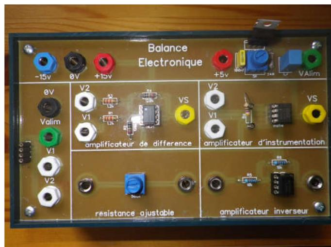
Photo 2 :Maquette des 2 amplificateurs de la Balance
