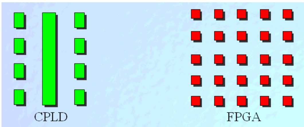
FIGURE 2.1 – Différences de structure des FPGA et CPLD
