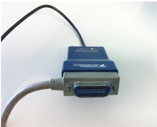
Figure 3.1 – Connecteur USB-GPIB (bleu) et câble GPIB (gris).
