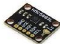
Figure 21 : le magnétomètre HMC5883L monté sur un PCB
