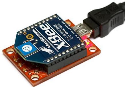
Xbee explorer USB avec XBee
