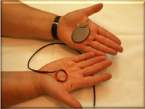
Image 3 : Un stimulateur cardiaque ainsi qu'une bobine prototype.<sup>55</sup>
