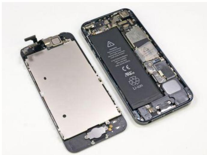
Figure 39: La batterie d'un Iphone5<sup>43</sup>
