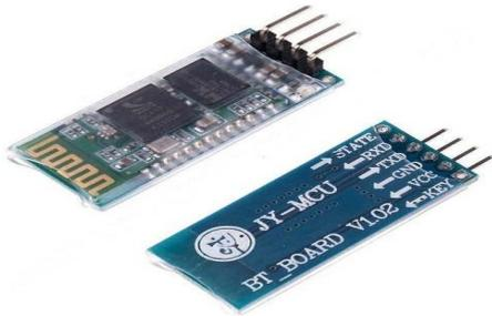
Le module Bluetooth nous permet de recevoir les données de la station météo en courte portée. Le signal transmit n'atteint qu'une dizaine de mètre mais elle nous permet de travailler sur un moyen de communication très utilisé. Ce module s'alimente entre 3,1V et 4,2V et consomme environ 30mA.
