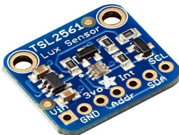
Le capteur d'irradiation TSL2561 nous permet de mesurer l'intensité de la lumière entre 0,1 et 40 000 Lux. Le capteur ne consomme que quelque centaine de micro ampère et s'alimente en 3,3V.
