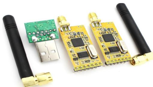
L'antenne APC220 est un moyen de recevoir les données de la station météo en longue portée. Le signal peut être transmise à plusieurs centaine de mètre même si entre le transmetteur et le receveur le signal rencontre des obstacles. Elle s'alimente entre 3,5V et 5,5V et elle a une broche d'activation EN, active lorsque la tension est supérieur à 1,6V ou à vide et en sommeil lorsque la tension est inférieur à 0,5V. L'antenne consomme environ 20mA.
