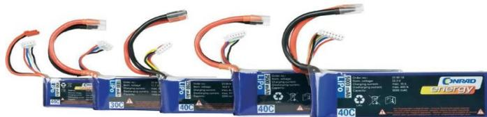
La batterie Lipo Conrad nous permet de rendre autonome la station météo en extérieur sans passer par une alimentation intérieur. La batterie délivre une tension de 3,7V, une capacité de 2100mAh, un courant de décharge max de 42A et un courant de charge max de 4,2A.
