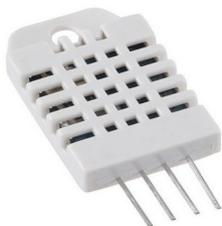
Le capteur de température & humidité DHT22 nous permet de mesurer une température entre -40°C et 80°C et de mesurer le taux d'humidité de 0 à 100%.
