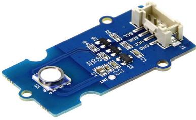
Le capteur de pression atmosphérique et altitude BMP280 nous permet de mesurer une pression entre 300 et 1100 hectoPascal. Le capteur ne consomme que quelque centaine de micro ampère et s'alimente entre 3,3V et 5V.
