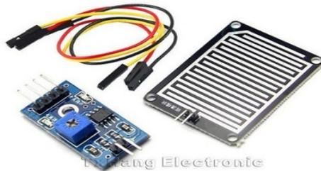
Le capteur de pluie LMK-47 protégé contre les oxydations nous permet de détecter la présence de pluie. Le capteur ne consomme que quelque centaine de micro ampère et s'alimente entre 3,3V et 5V.
