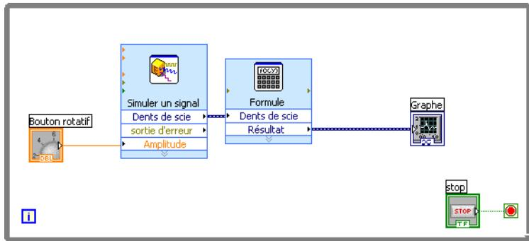
Figure 1-8. Diagramme du VI Acquérir un signal
