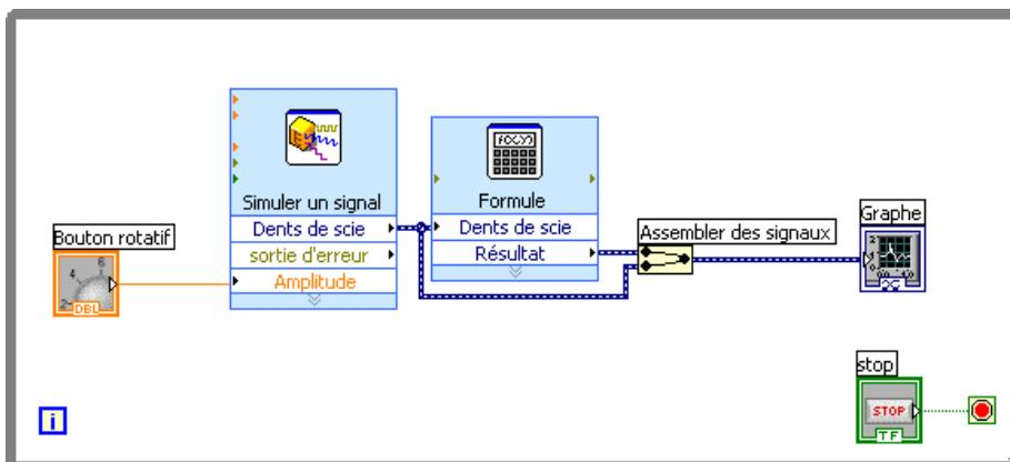
**Figure 1-9.** Diagramme représentant la fonction Assembler des signaux
