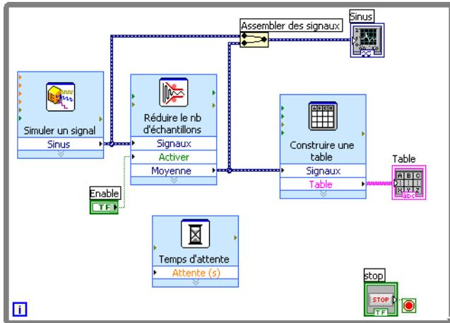
**Figure 2-5.** Diagramme du VI Réduire le nombre d'échantillons
