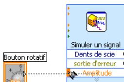
5. Quand l'outil Bobine apparaît, cliquez sur la flèche du terminal **Bouton rotatif**, puis sur la flèche de l'entrée **Amplitude** du VI Express Simuler un signal, illustré à gauche, pour câbler les deux objets l'un à l'autre.
