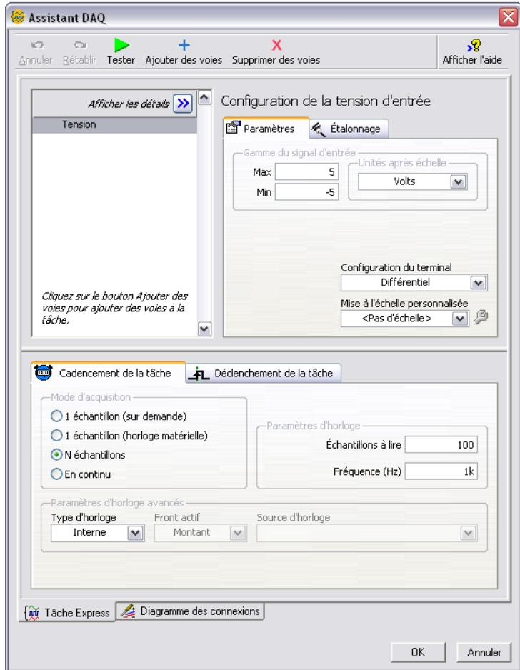
Figure 4-1. Configuration d'une tâche avec l'Assistant DAQ
