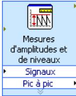
La sortie **Moyenne quadratique** du VI Express Mesures d'amplitudes et de niveaux change pour tenir compte de la nouvelle sortie **Pic à pic**, comme illustré à gauche.
