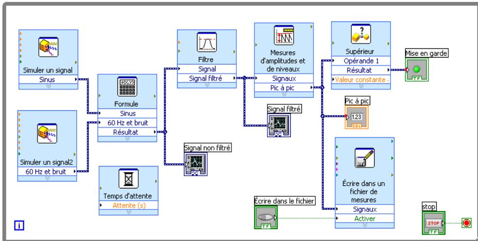
Figure 3-6. Diagramme du VI Enregistrement des données
