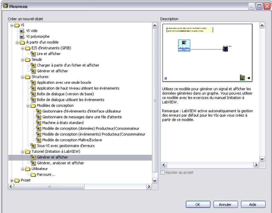
4. Cliquez sur le bouton **OK** pour créer un VI à partir du modèle. Vous pouvez également double-cliquer sur le nom du VI modèle dans la liste de **Créer un nouvel objet** pour créer un VI à partir d'un modèle.
