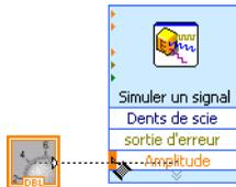
Un câble apparaît et connecte les deux objets. Les données circulent sur ce fil, du terminal Bouton rotatif au VI Express.
