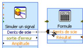
13. Avec l’outil Bobine, connectez la sortie **Résultat** du VI Express Formule au terminal **Waveform Graph**.
