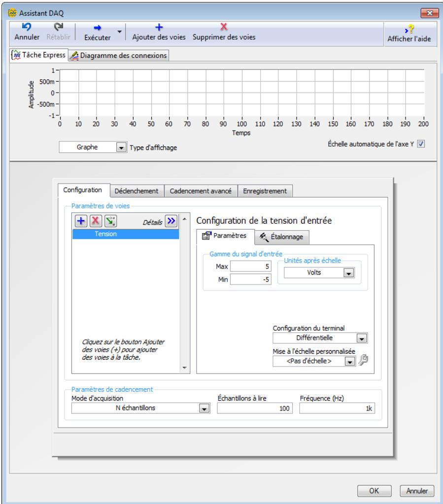
7. Dans la boîte de dialogue de l'Assistant DAQ, sélectionnez l'onglet **Configuration** et trouvez la section **Configuration de la tension d'entrée**.
