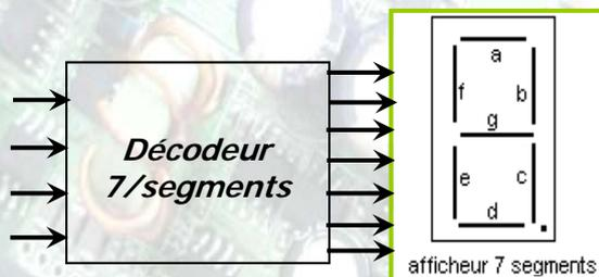
**Proposer un schéma structurel d'un décodeur BCD/7segments :**
