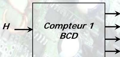
**Proposer un schéma structurel du compteur 1 :** donner la table de vérité, karnaugh, la réalisation à l'aide de bascules D:7474 et de portes logiques.
