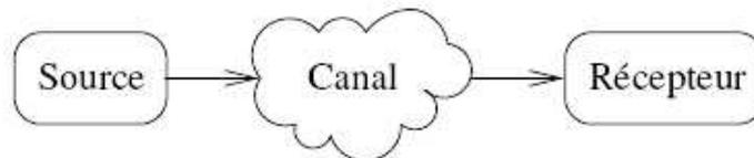
Le canal transporte l'information entre la source et le récepteur. Lorsque la transmission se fait sur un support qui laisse passer le spectre de la source, la transmission s'effectue en bande de base. Ce canal est en général perturbé (bruit, interférences, perturbations atmosphériques et réflexions sur des obstacles lors de la propagation, ...).
