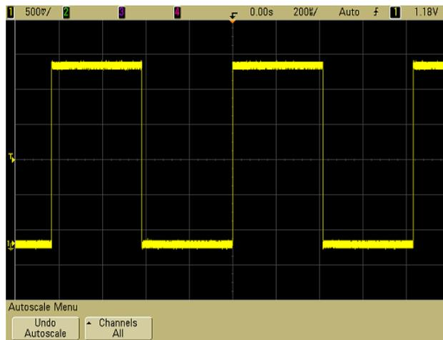
Si vous voyez le signal mais que sa forme carrée n'est pas aussi parfaite que celle représentée ci-dessus, effectuez la procédure décrite à la section "[Compensation des sondes de l'oscilloscope](#)" page 37.
