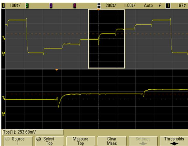
**Figure 34** Isolation d'une zone à des fins de mesure du sommet
