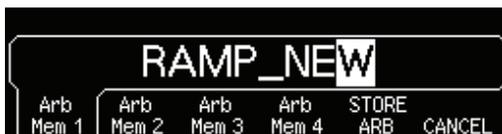
Le signal est maintenant enregistré en mémoire non volatile et est actuellement délivré en sortie du générateur. Le nom sous lequel vous l'avez sauvegardé doit apparaître dans la liste des signaux enregistrés (sous la touche de fonction **Stored Wform**).
