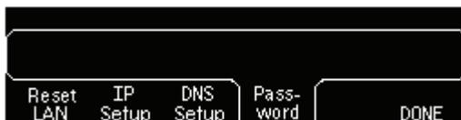
Dans ce menu, vous pouvez sélectionner **Reset LAN** pour réinitialiser la configuration LAN, **IP Setup** pour définir une adresse IP et les paramètres apparentés, **DNS Setup** pour configurer l'adresse DNS ou **Password** pour définir un mot de passe pour l'interface de serveur Web.
