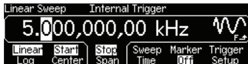
A ce point précis, le générateur de fonctions délivre un balayage continu entre 50 Hz et 5 kHz (si la sortie est activée).
