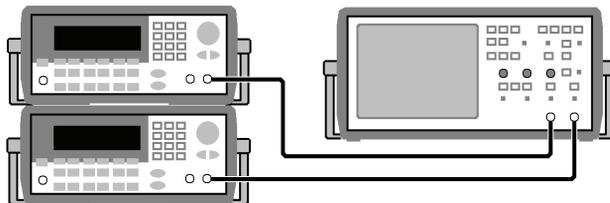
3. Définissez la même fréquence sur les deux générateurs de fonction. L'oscilloscope doit afficher des signaux synchronisés quant à la
