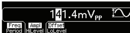
Pour modifier l'amplitude affichée par *décades*, appuyez sur la touche fléchée vers la droite pour placer le curseur sur les unités du côté droit de l'écran. Puis, tournez le bouton rotatif pour augmenter ou diminuer l'amplitude par décades.
