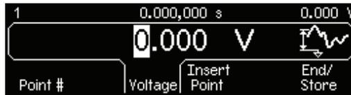
L'éditeur de signal effectue tous les calculs d'amplitude en volts crête à crête ( $V_{pp}$ ) plutôt qu'en volts efficaces ( $V_{rms}$ ) ou en dBm.
