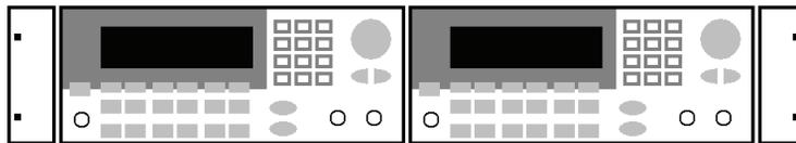
Pour monter deux instruments côte-à-côte dans un rack, commandez le kit de liaison 5061- 8769 et le kit de cornière 5063-9212. Veillez à utiliser les rails de support à l'intérieur du rack.
