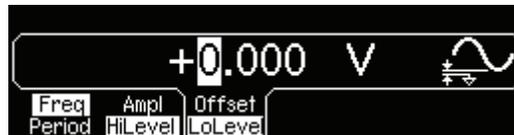
Notez que ces réglages (high-level (niveau haut) = "1.0 V" et low-level (niveau bas) = "0.0 V") sont équivalents à un réglage d'amplitude de "1.0 Vpp" et de tension continue de décalage de "500 mVcc".
