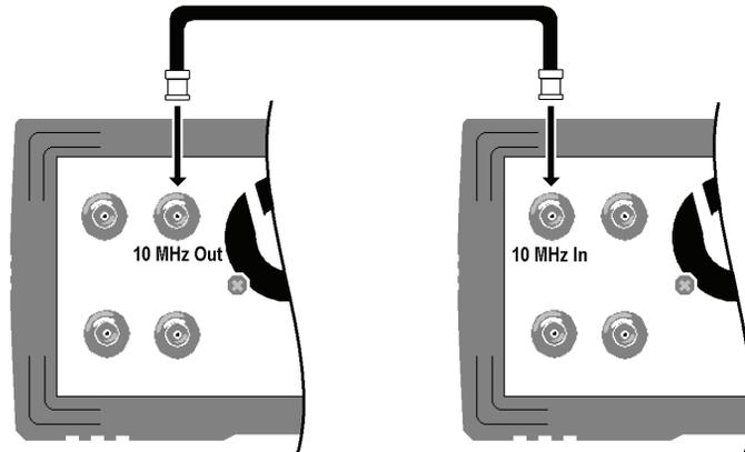
**Remarque :** *Vous pouvez utiliser les commandes de verrouillage de phase décrites ci-dessous pour synchroniser plusieurs instruments 33220A uniquement si **tous** disposent de l'option 001, Référence de base de temps externe. Cette option comprend les connecteurs de la face arrière "10 MHz Out" et "10 MHz In", ainsi que les circuits nécessaires à la synchronisation des instruments.*
