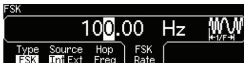
*A ce point précis, le générateur de fonctions délivre un signal FSK (si la sortie est activée).*
