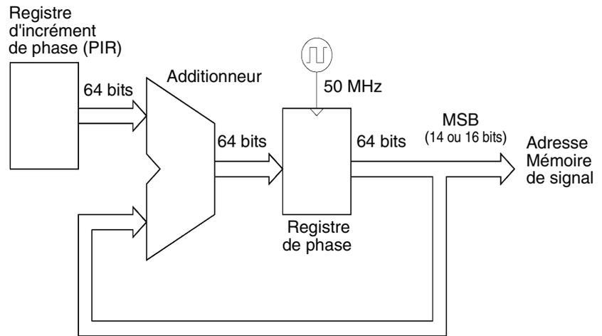
*Circuit de l'accumulateur de phases*
