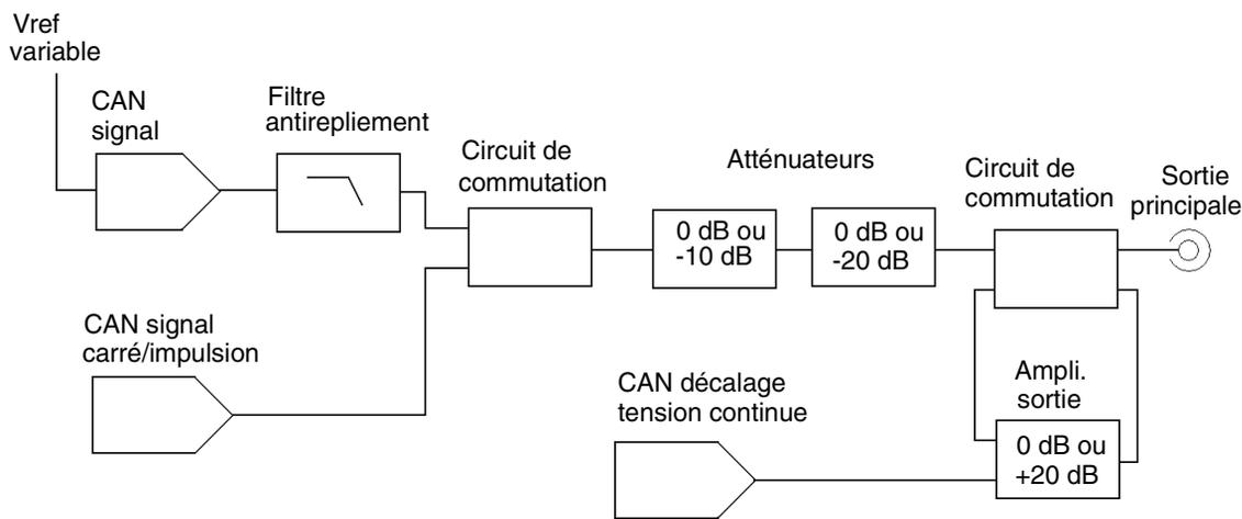
Notez que la tension continue de décalage est ajoutée au signal ca au niveau de l'amplificateur de sortie. Ceci permet le décalage de signaux d'amplitude relativement faible par des tensions continues relativement importantes. Par exemple, vous pouvez décaler un signal de 100 mVpp de près de 5 Vcc (dans une charge de 50  $\Omega$ ).
