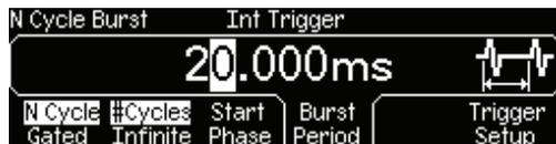
*A ce point précis, le générateur de fonctions délivre un signal en rafale de trois cycles en continu (si la sortie est activée).*
