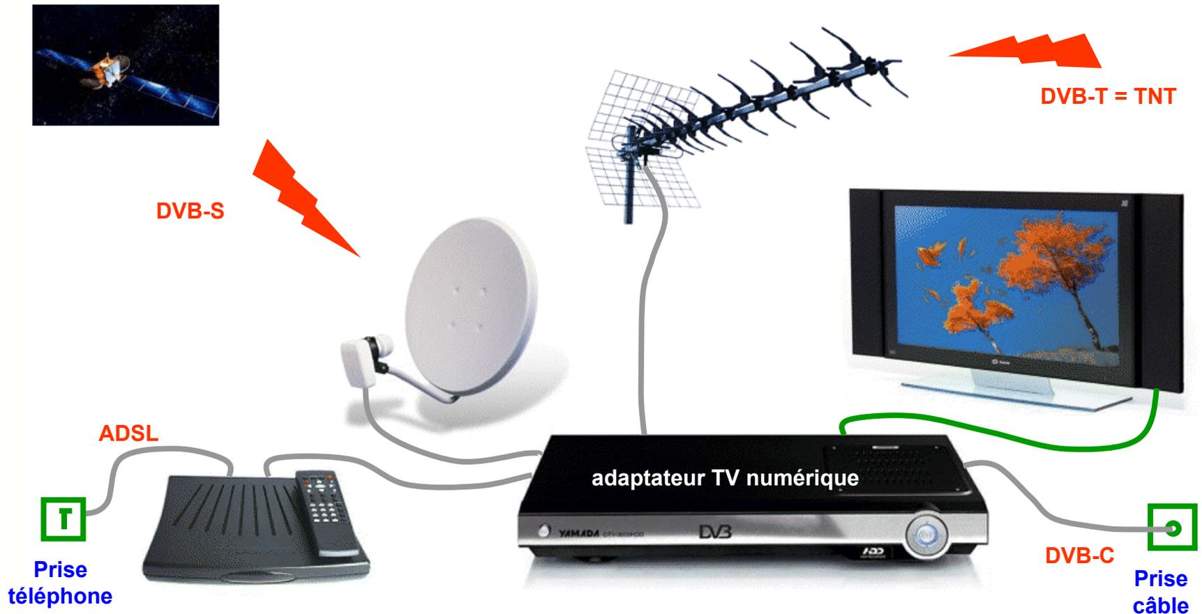
Historiquement, la télévision numérique a d'abord été diffusée par le satellite (norme DVB-S) et le câble (norme DVB-C) avant de l'être par voie hertzienne terrestre (norme DVB-T). Elle est aussi disponible en France par la ligne téléphonique (ADSL).
