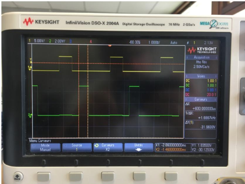
Visualisation sur l'oscilloscope des signaux TRIG et ECHO du capteur d'altitude
