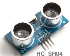
$$(\text{Durée de l'état haut en } \mu\text{s}) / 58 = \text{Distance en cm}$$
